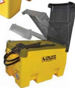
Tanks für Öltransport aus linearem Polyethylen, rundformgepresst, mit verschließbarem Deckel, Füllstopfen aus Aluminium, Sicherheitsventil, Umfüllungseinheit, integrierte Staplertaschen zum Anheben auch im vollbeladenem Zustand. Integrierte Tragegriffe für das Anheben im leeren Zustand. Sämtliche Einsätze sind aus eloxiertem Aluminium oder Messing hergestellt.
